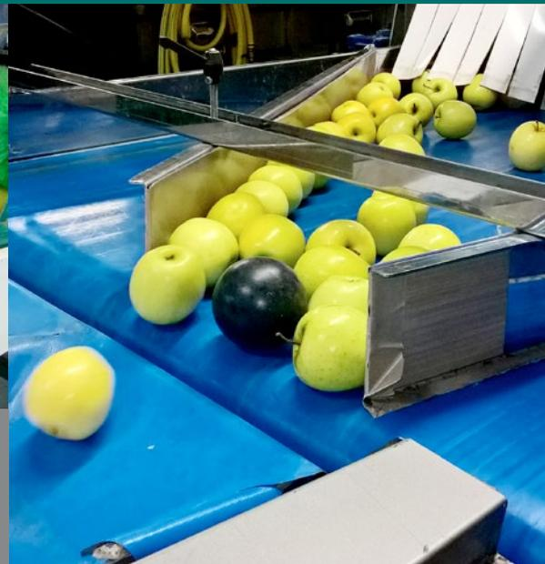
Le CTIFL réalise le diagnostic à l'aide de la sphère instrumentée. Elle détecte les points critiques de vos machines de conditionnement et permet de quantifier les risques de chocs pour les fruits.
